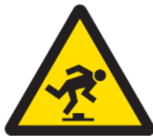
Riesgo de tropezar
