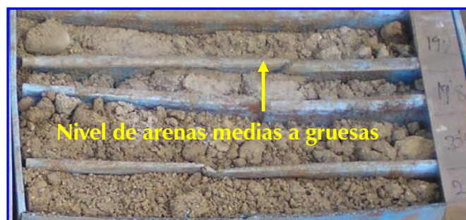
Figura 8. Aspecto que presenta la unidad de arenas medias a gruesas.
