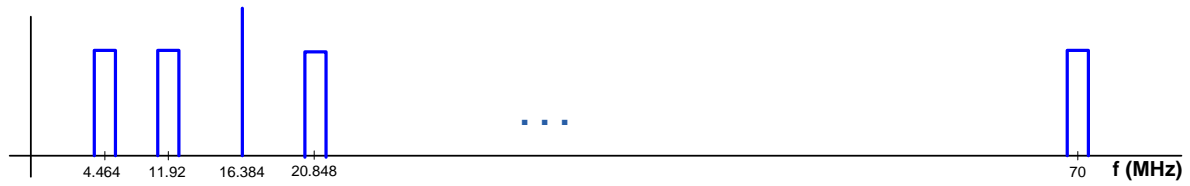
Figura 9 - Réplicas a baja frecuencia de la señal muestreada
